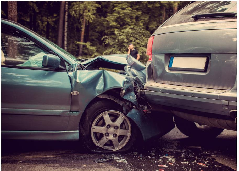
Imagen: Accidente tráfico implicado 2 vehículos. (Airbag saltados en vehículo trasero, gran deformidad de capó)
